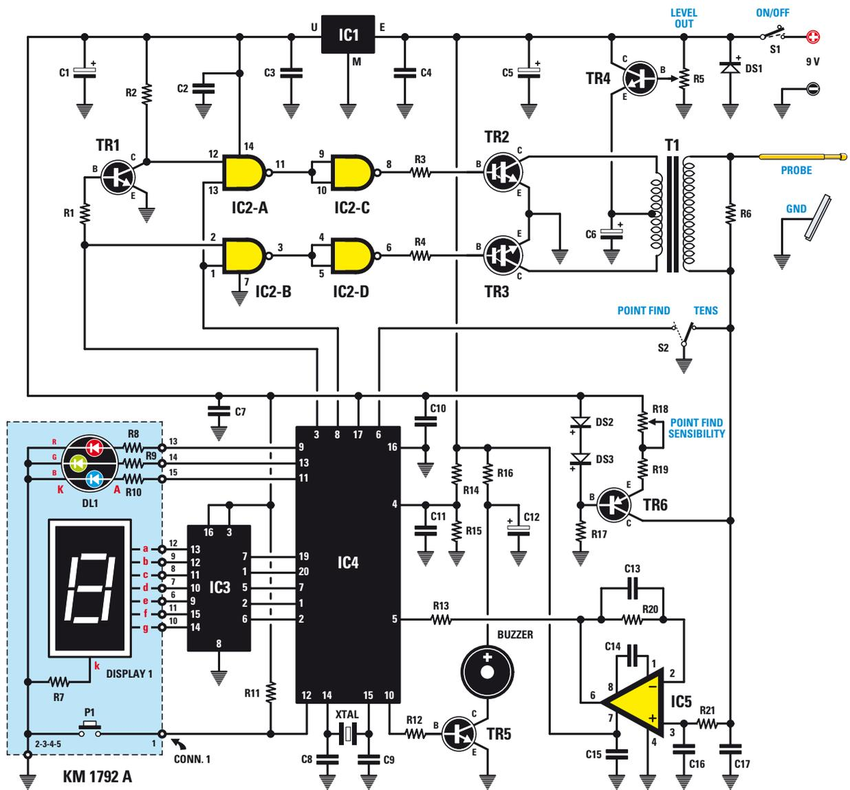
**Fig.5** Schema elettrico del progetto dell'elettroreflex LX.1792. A sinistra nel riquadro azzurro i componenti relativi al KM1792A che forniamo già montato.
