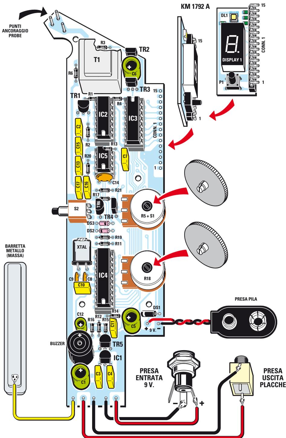
**Fig.7 Schema pratico dell'elettroreflex LX.1792. Come potete vedere il piccolo circuito stampato in SMD KM1792A va innestato su quest'ultimo per mezzo del connettore 15 poli seguendo l'orientamento indicato dalla freccia.**
