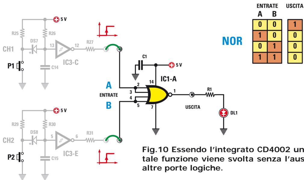
Fig.10 Essendo l'integrato CD4002 un NOR, tale funzione viene svolta senza l'ausilio di altre porte logiche.
