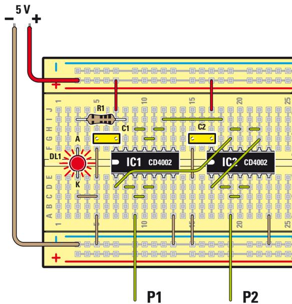
Collegando in uscita una ulteriore porta **inverter**, si ottiene la funzione **NAND** che genera un livello logico di **uscita 0** quando **tutti gli ingressi** sono a **livello logico 1**.
