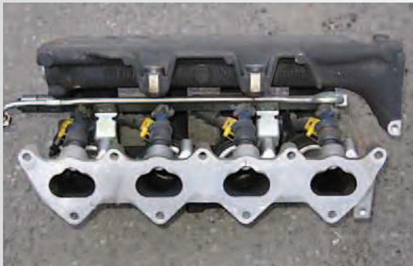
**Fig.10** Foto degli iniettori innestati nel distributore combustile.
