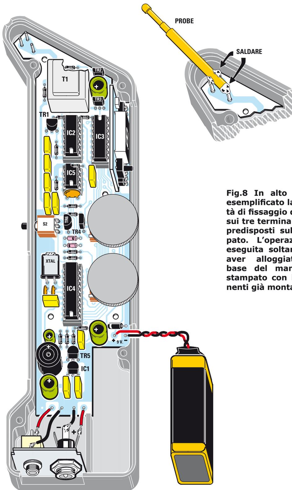
**Fig.8** In alto abbiamo esemplificato la modalità di fissaggio del probe sui tre terminali a spillo predisposti sullo stampato. L'operazione va eseguita soltanto dopo aver alloggiato sulla base del manopolo lo stampato con i componenti già montati.
