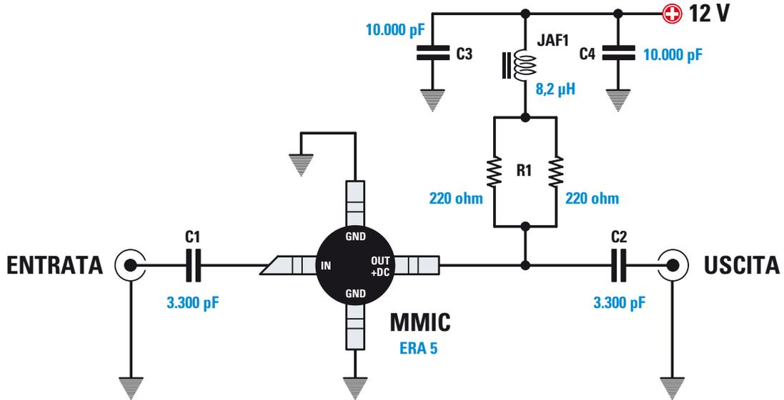
**Fig.8 Aggiungendo in serie alla resistenza di limitazione l'impedenza JAF1 si ottiene un incremento del guadagno e si migliora il ROS di uscita. L'impedenza non deve avere la frequenza di autorisonanza all'interno della banda di utilizzo.**
