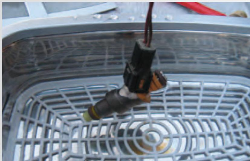
**Fig.12** Per una pulizia più accurata, vi consigliamo di utilizzare una lavatrice ad ultrasuoni riscaldata a 70 gradi.
