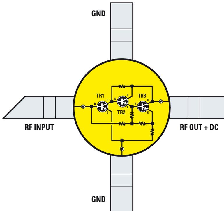
**Fig.1** All'interno del minuscolo contenitore è presente un completo circuito di amplificazione composto da diversi transistor per alta frequenza. Il pin di uscita RFOUT+DC è comune a quello di alimentazione. Si notino i due pin di massa.
