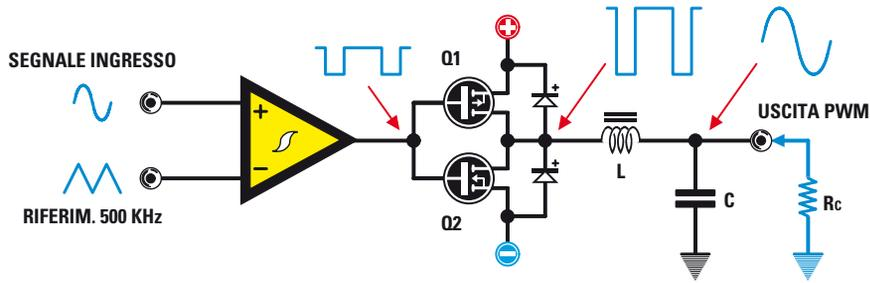
Fig. 3 Schema di massima di un amplificatore in classe D e relative forme d'onda.
