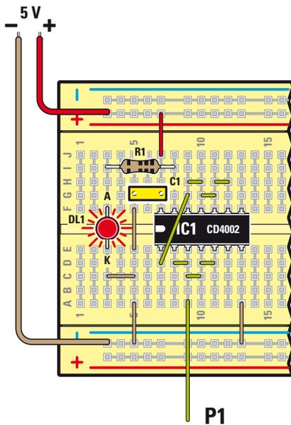
Per realizzare la funzione **"buffer"**, dovrete montare questo circuito in cui due inverter sono connessi in "cascata".
