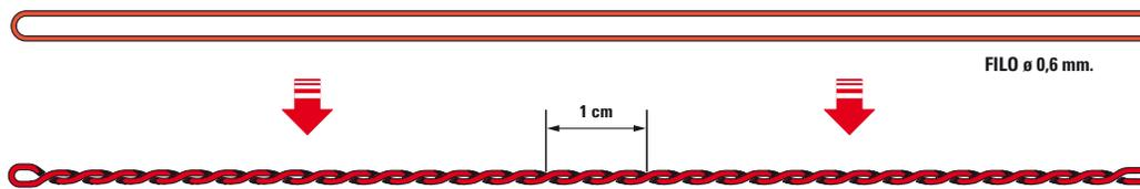
**Fig.9** Per realizzare i trasformatori T1-T2-T3 dovreste innanzitutto realizzare una trecchia con del filo dal diametro di 0,6 mm. Come indicazione di massima, 1 cm di trecchia è costituita da 3 avvolgimenti (vedi disegno).
