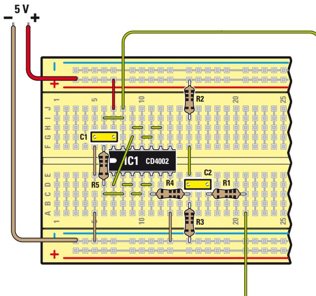
Per realizzare il circuito **squadratore** viene utilizzato un solo integrato **CD4002**, ma alcuni componenti passivi in più rispetto alle altre applicazioni.
