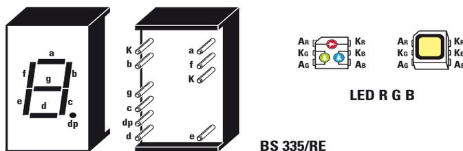
**Fig.6** Connessioni del display e del led RGB che troverete già montati sullo stampato KM1792A.
