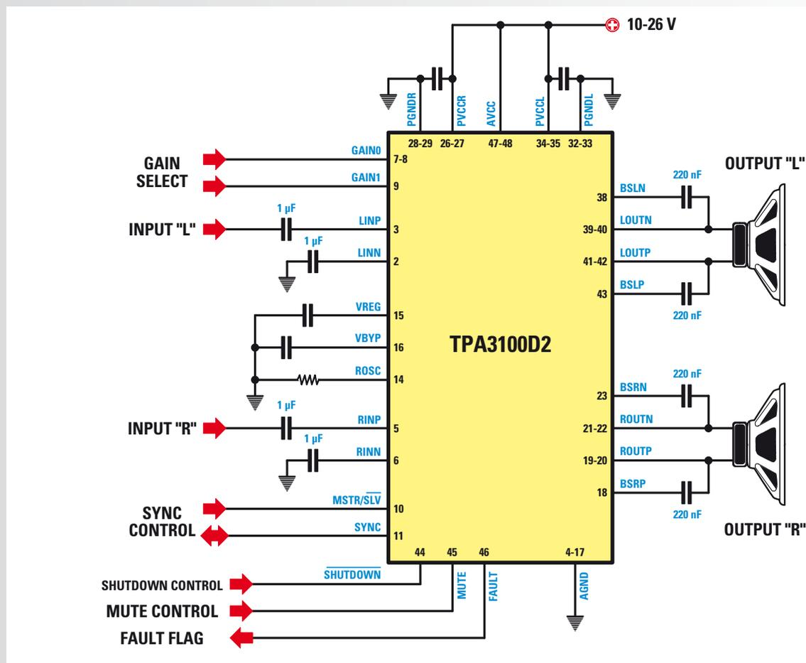
Fig.9 Per farvi meglio comprendere il principio di funzionamento dell'integrato TPA3100D2 in figura vi proponiamo il suo schema di funzionamento semplificato. Per informazioni più dettagliate vi rimandiamo alla lettura dell'articolo.
