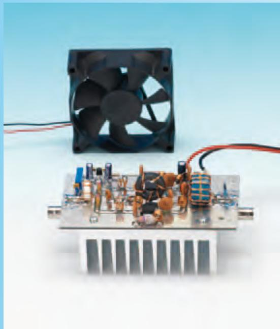
**Fig.17** Nel caso vi troviate a lavorare con potenze di uscita superiori ai 10 Watt e per periodi di tempo piuttosto lunghi, vi consigliamo di direzionare una piccola ventola di raffreddamento verso il circuito e in particolare verso i trasformatori che tendono a surriscaldarsi durante il funzionamento.
