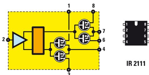
Fig.4 A lato, schema a blocchi dell'integrato IR2111 e relative connessioni con la tacca di riferimento a U orientata verso l'alto.
