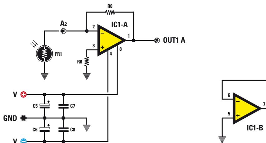
In figura è riprodotto l'integrato **IC1/A** collegato come convertitore corrente/tensione per **convertire** la corrente che attraversa **FR1** in una **tensione**.
