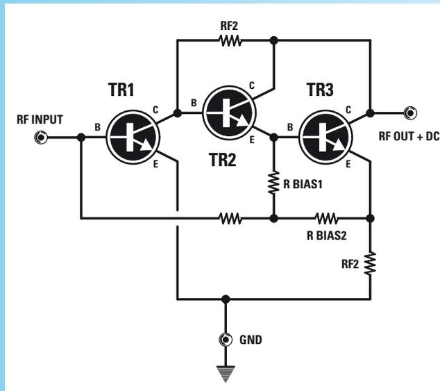
**Fig.2 Schema interno di un tipico amplificatore MMIC.**
