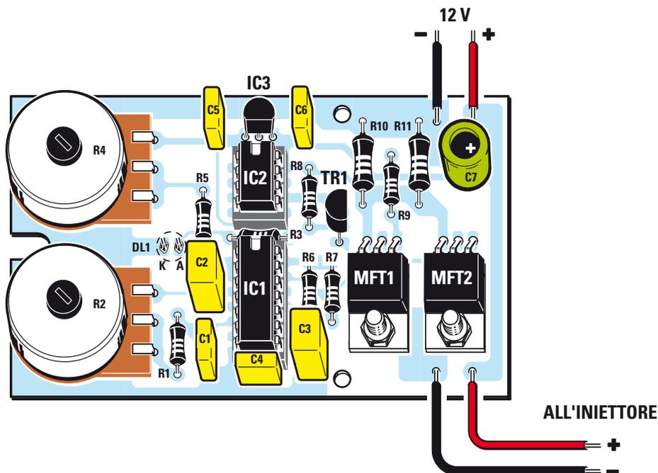
**Fig.5** Schema pratico di montaggio del circuito stampato del prova iniettori LX.1971. Seguendo le indicazioni fornite nell'articolo non incontrerete particolari difficoltà a portarne a termine la realizzazione.
