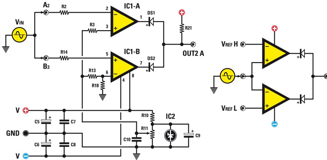
In figura è riprodotto lo schema di un comparatore a finestra. Per capirne meglio il funzionamento conviene osservare lo schema semplificato visibile a destra.
