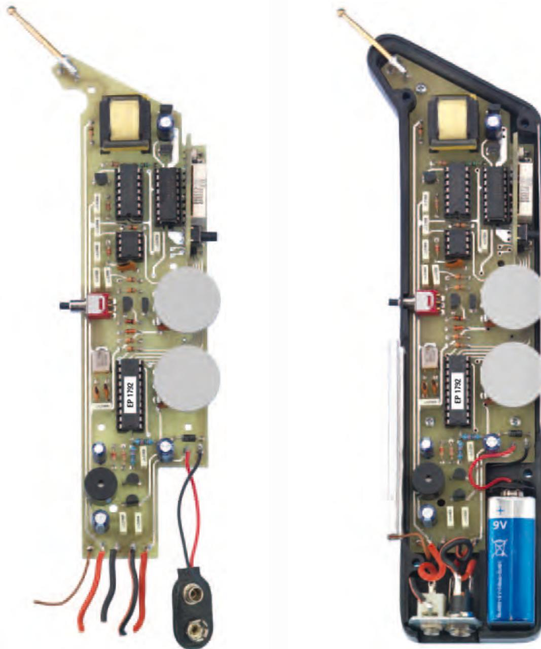
**Fig.9 A sinistra foto dello schema pratico di montaggio dell'elettroreflex e, a destra, lo stesso fissato alla base del manipolo appositamente realizzato.**
