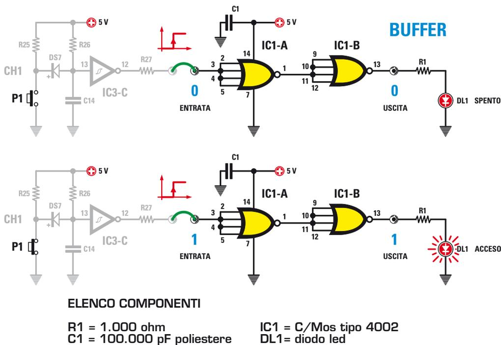
Fig.8 Invertendo due volte il livello logico d'ingresso si ottiene un buffer.
