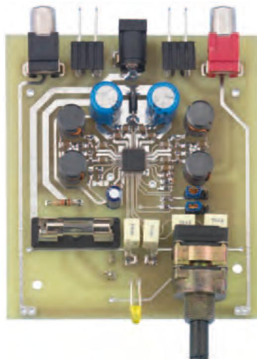
Fig.17 Foto dell'amplificatore realizzato per i nostri test di laboratorio, inserito nel mobile metallico appositamente predisposto. Qui sopra il circuito inserito nel mobile e visto in sezione frontale e posteriore.
