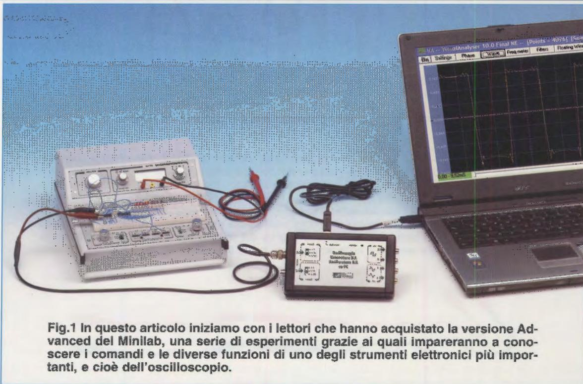
**Fig.1** In questo articolo iniziamo con i lettori che hanno acquistato la versione **Advanced** del **Minilab**, una serie di esperimenti grazie ai quali impareranno a conoscere i comandi e le diverse funzioni di uno degli strumenti elettronici più importanti, e cioè dell'**oscilloscopio**.
