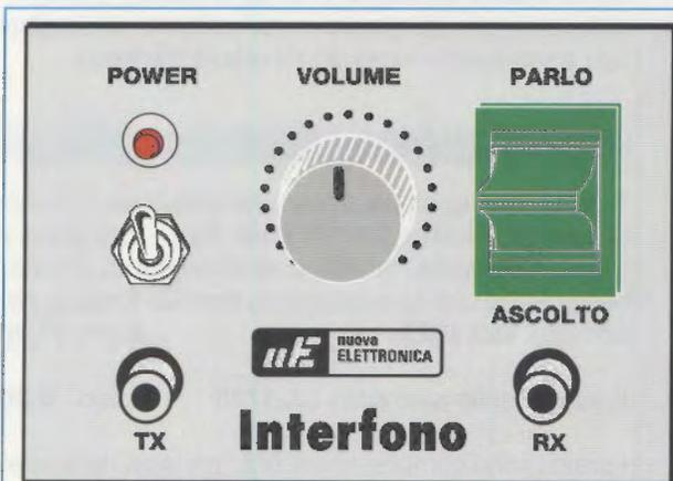
Fig.6 Sul pannello frontale del mobile troveranno posto il doppio deviatore **S1** di Parlo o Ascolto, la manopola del Volume, il diodo led e l'interruttore **S2** Power. I due fori indicati **TX** e **RX** servono per innestare gli spinotti Jack delle Casse Acustiche.
