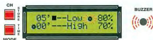
Allo stesso tempo viene **tolta l'eccitazione** al trasduttore e sul display vengono **ricaricati** nuovamente il valore di **tempo** e il **modo** precedentemente memorizzato, ma non il valore della **potenza**, che dovrà sempre essere regolata manualmente dall'**operatore**.
