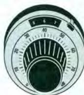
Fig.6 Con il potenziometro multigiri, è possibile misurare con precisione il **Delay Time**, cioè la distanza tra l'inizio della traccia e il punto nel quale si trova quella parte di segnale che si desidera espandere.
