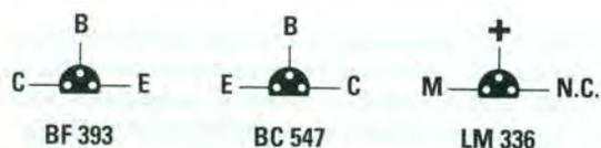
Connessioni viste da SOTTO dei terminali dei transistor siglati **BF.393 - BC.547** e del diodo zener **LM.336** (vedi **IC3**).
