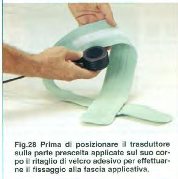
Fig.28 Prima di posizionare il trasduttore sulla parte prescelta applicate sul suo corpo il ritaglio di velcro adesivo per effettuare il fissaggio alla fascia applicativa.
