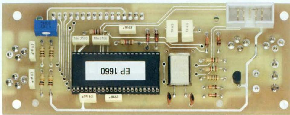
Fig.19 Foto del circuito stampato del display visto dal lato opposto a quello del display. Al centro potete notare la sagoma del microprocessore ST7 siglato EP1660 e, alla sua destra, quella del quarzo da 8 MHz che dovreste montare in posizione orizzontale.
