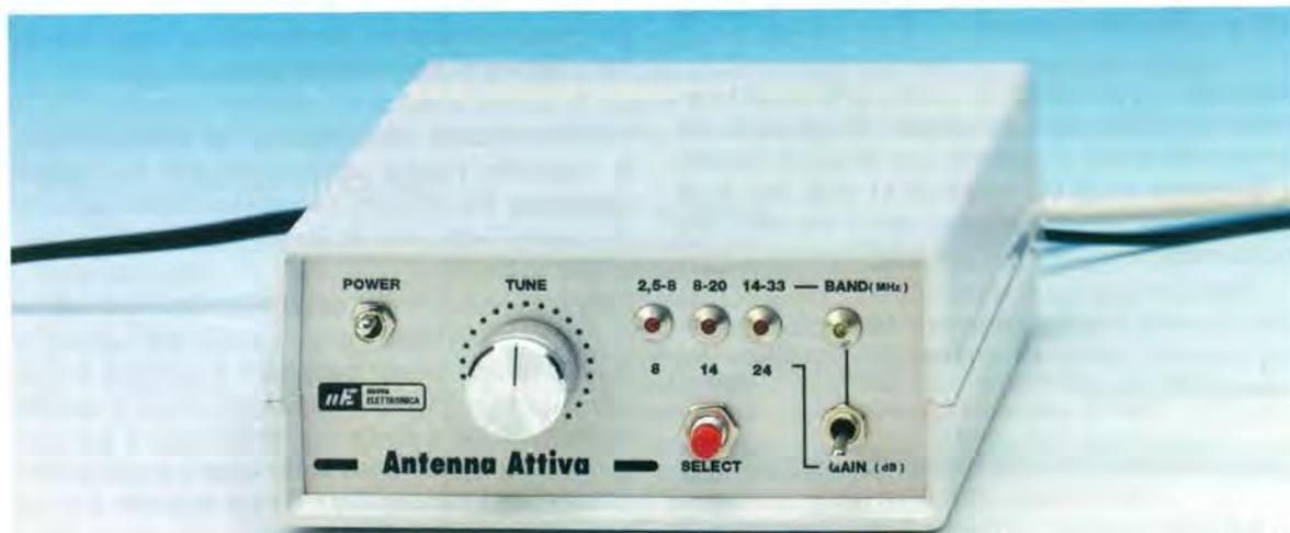
Fig.1 Ecco come si presenta il mobile della Centralina di Comando LX.1657 che andrà collocato vicino al ricevitore che si vuole sensibilizzare (vedi fig.2). Il deviatore a levetta S1 e il pulsante Select permettono di selezionare la Banda e il Guadagno.
