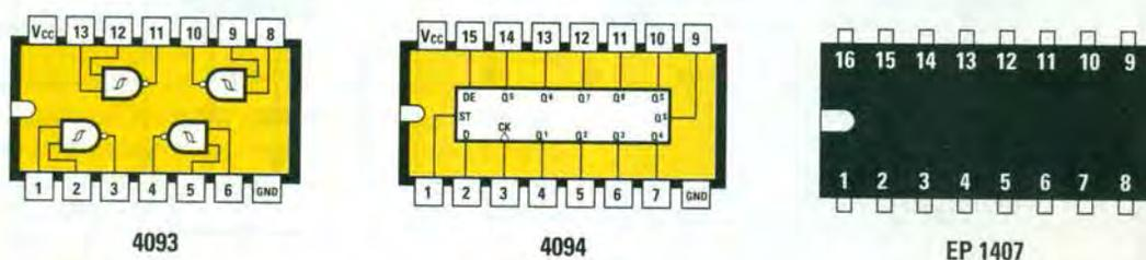
**Fig.5** Connessioni dei 3 integrati visti da SOPRA con le tacche di riferimento a forma di U rivolte verso sinistra. L'integrato **EP.1407** è un microprocessore **ST6** (vedi **IC2**) che vi forniamo già programmato per far funzionare il contatore Geiger.
