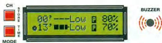
Anche al secondo trasduttore viene **tolta l'eccitazione** mentre il display ricarica automaticamente **tempo** e **modo** relativi alla seduta **memorizzata**.
