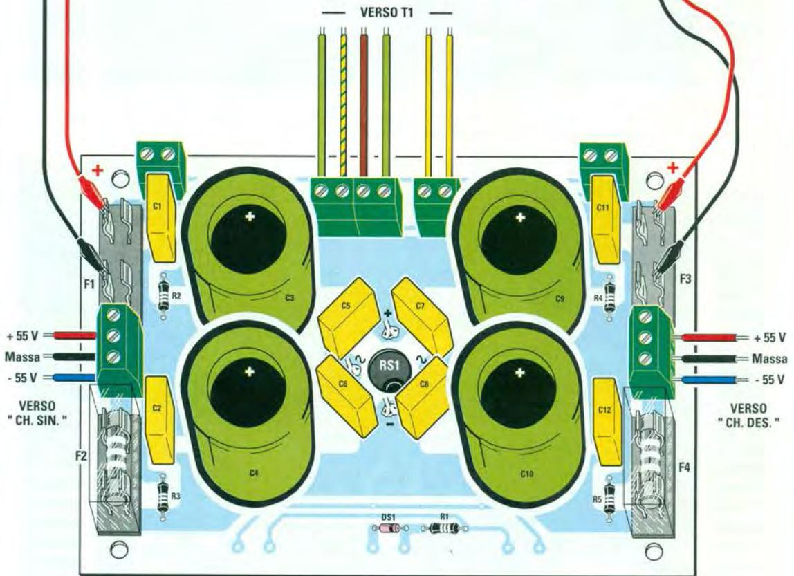
Fig.21 Per tarare la corrente a riposo del canale sinistro, inserite nella sua base d'appoggio il solo fusibile F2 e collegate i puntali del tester al supporto del fusibile F1 come evidenziato in figura. Effettuata la taratura, spegnete il finale ed aspettate che i condensatori elettrolitici si scarichino, prima di togliere il fusibile F2 ed inserire il fusibile F4, che vi serve per tarare la corrente a riposo del canale destro.
