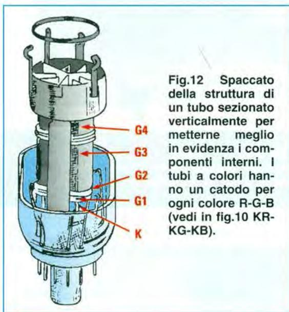
Fig.12 Spaccato della struttura di un tubo sezionato verticalmente per metterne meglio in evidenza i componenti interni. I tubi a colori hanno un catodo per ogni colore R-G-B (vedi in fig.10 KR-KG-KB).
