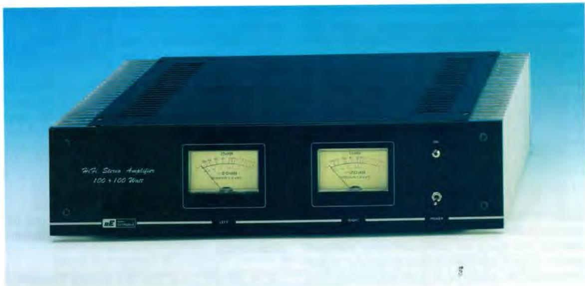
Se cercate lo schema di un amplificatore che non sia solo stato progettato sulla carta, ma sia stato anche realizzato e sottoposto ad ogni tipo di collaudo, avete trovato ciò che fa al caso vostro: un amplificatore stereo hi-fi con finali a FET e MOSFET da 100+100 watt RMS completo di uno stadio di protezione antibump per gli altoparlanti.
