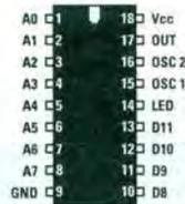
Fig.12 Di lato, le connessioni dell'integrato siglato HT.6014 e sotto lo schema a blocchi interno dello stesso integrato.
