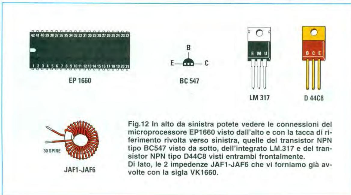
Fig.12 In alto da sinistra potete vedere le connessioni del microprocessore EP1660 visto dall'alto e con la tacca di riferimento rivolta verso sinistra, quelle del transistor NPN tipo BC547 visto da sotto, dell'integrato LM.317 e del transistor NPN tipo D44C8 visti entrambi frontalmente. Di lato, le 2 impedenze JAF1-JAF6 che vi forniamo già avvolte con la sigla VK1660.
