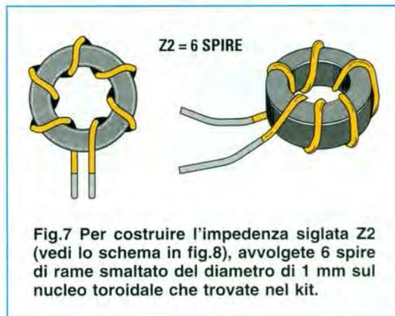
**Fig.7** Per costruire l'impedenza siglata **Z2** (vedi lo schema in fig.8), avvolgete **6 spire** di rame smaltato del diametro di **1 mm** sul nucleo toroidale che trovate nel kit.
