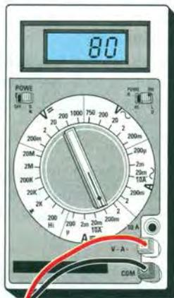
Nota: per tarare la corrente a riposo di ciascun canale, impostate il tester sulla portata di 200 mA cc fondo scala, quindi ruotate in senso orario il trimmer R14, che si trova sullo stadio amplificatore LX.1650, fino a leggere sul tester una corrente di 80 mA.
