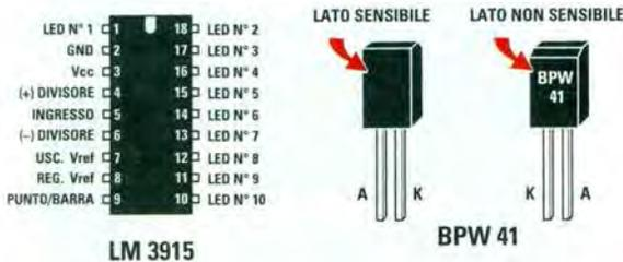
Fig.19 A sinistra le connessioni viste da sopra dell'integrato LM.3915. Precisiamo che il lato sensibile del sensore ricevente BPW.41 è quello sul quale **NON** appare nessuna scritta. Se inserite questo diodo sul circuito stampato in senso inverso, non potrà captare nessun segnale infrarosso.
