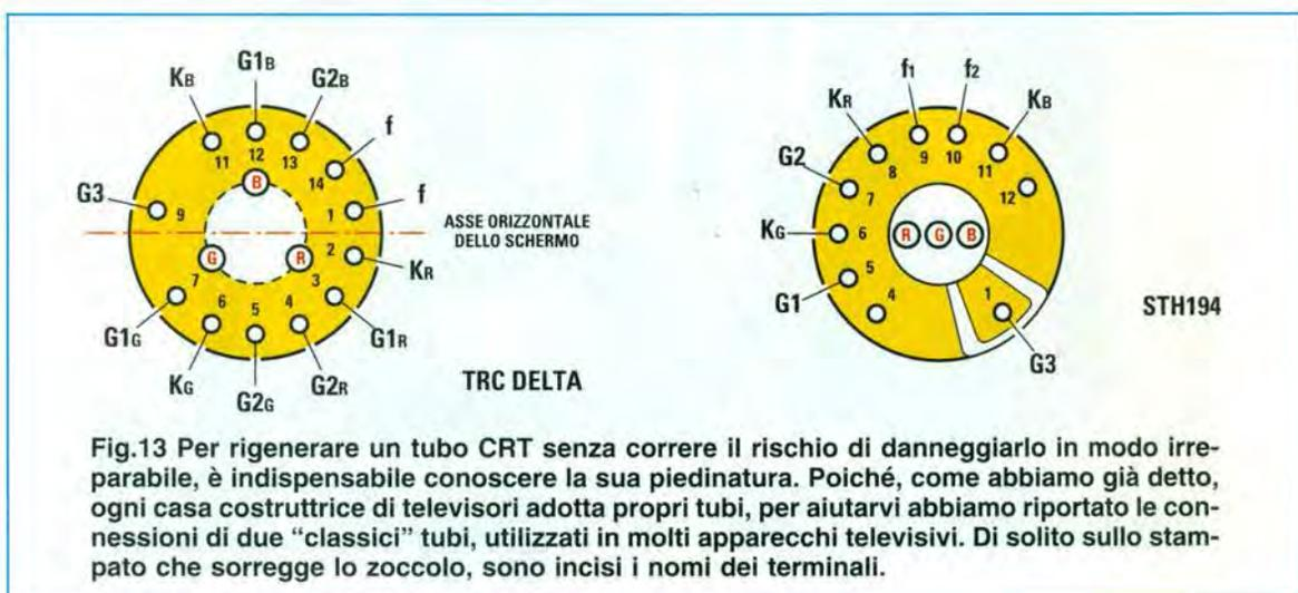
Fig.13 Per rigenerare un tubo CRT senza correre il rischio di danneggiarlo in modo irreparabile, è indispensabile conoscere la sua piedinatura. Poiché, come abbiamo già detto, ogni casa costruttrice di televisori adotta propri tubi, per aiutarvi abbiamo riportato le connessioni di due "classici" tubi, utilizzati in molti apparecchi televisivi. Di solito sullo stampato che sorregge lo zoccolo, sono incisi i nomi dei terminali.
