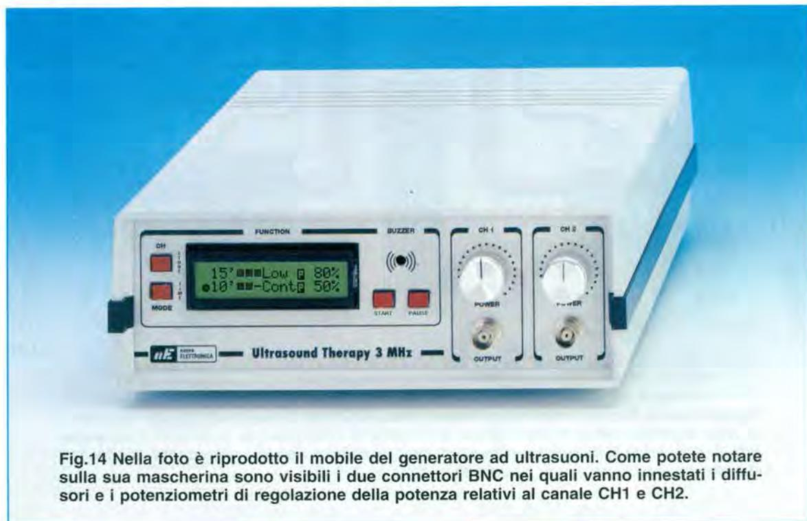
**Fig.14** Nella foto è riprodotto il mobile del generatore ad ultrasuoni. Come potete notare sulla sua mascherina sono visibili i due connettori BNC nei quali vanno innestati i diffusori e i potenziometri di regolazione della potenza relativi al canale CH1 e CH2.
