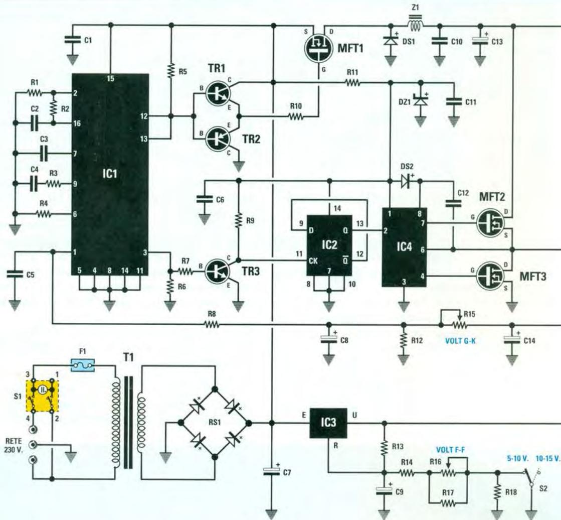
Fig.2 Schema elettrico del rigeneratore di tubi a raggi catodici. Questo circuito fornisce la tensione e la corrente necessarie a stimolare l'emissione di elettroni dal catodo verso l'anodo fornendo nel contempo dei picchi di alta tensione per "ripulire" il catodo dal micrometrico strato di elettroni che non riusciti a raggiungere lo schermo.
