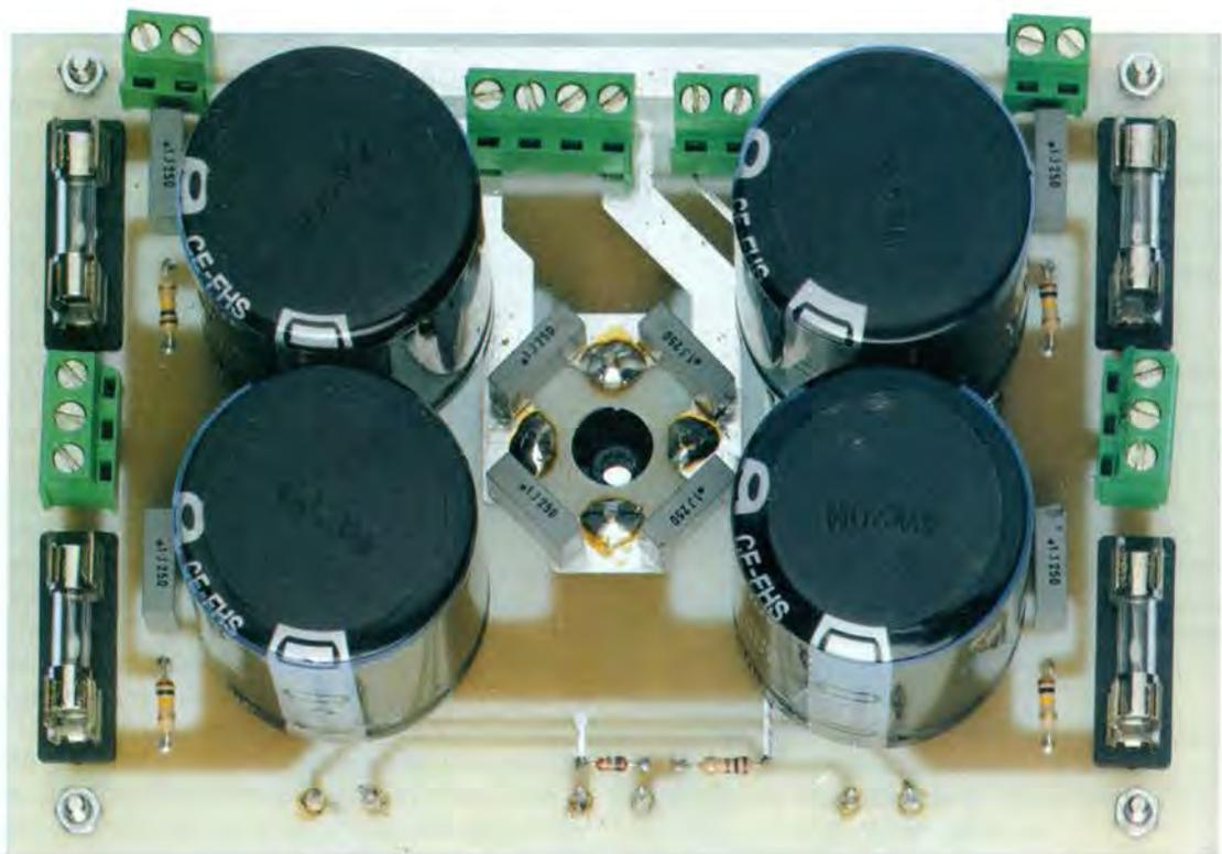
**Fig.9** Foto del circuito stampato dell'alimentatore siglato **LX.1649** ripresa dal lato dei componenti. Sebbene i quattro fusibili siano nelle loro basi d'appoggio, voi non inseriteli perché il controllo del valore della tensione d'uscita va effettuato senza fusibili.
