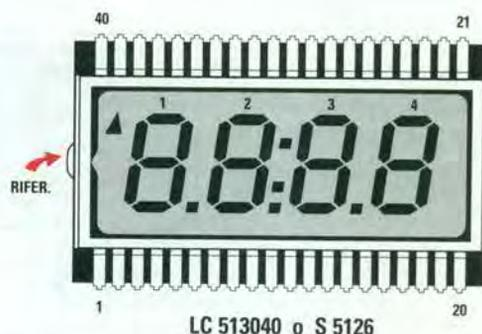
**Fig.4** Quando inserite il display nei due connettori, controllate che la **piccolissima** protuberanza in vetro (vedi Rifer.) risulti rivolta verso sinistra. Come riferimento può essere presente anche un segno < sulla cornice interna del display (vedi fig.6).
