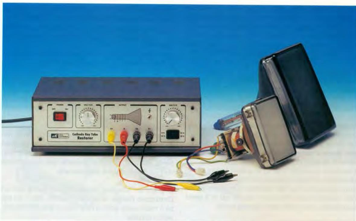
A mano a mano che il tubo a raggi catodici del televisore invecchia, perde di luminosità. L'apparecchio che vi proponiamo è in grado di rigenerare il tubo restituendogli pressoché tutte le proprietà che aveva all'origine.
