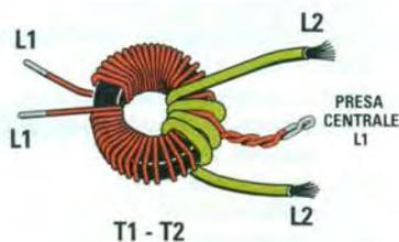
Fig.4 Sui due nuclei toroidali dei trasformatori T1 e T2 che vi vengono forniti con la bobina L1 già avvolta e completa della sua presa centrale, dovrete solo avvolgere le 4 spire per la bobina L2, utilizzando del sottile filo in rame flessibile isolato in plastica.
