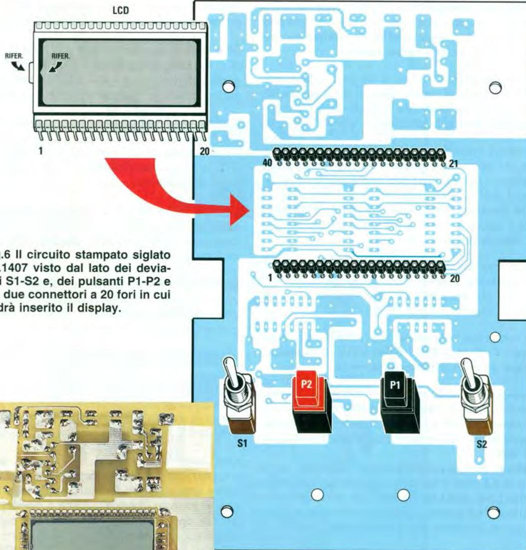
Fig.6 Il circuito stampato siglato LX.1407 visto dal lato dei deviatori S1-S2 e, dei pulsanti P1-P2 e dei due connettori a 20 fori in cui andrà inserito il display.
