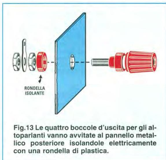
**Fig.13** Le quattro boccole d'uscita per gli altoparlanti vanno avvitate al pannello metallico posteriore isolandole elettricamente con una rondella di plastica.
