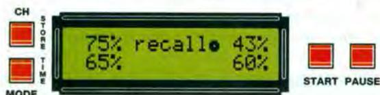
L'asterisco che segue la scritta **RECALL** si posiziona sul canale **CH1** ad indicare che dobbiamo eseguire la regolazione del potenziometro relativo a questo canale.
