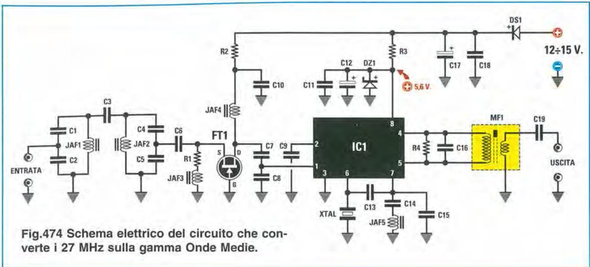
Fig.474 Schema elettrico del circuito che converte i 27 MHz sulla gamma Onde Medie.
