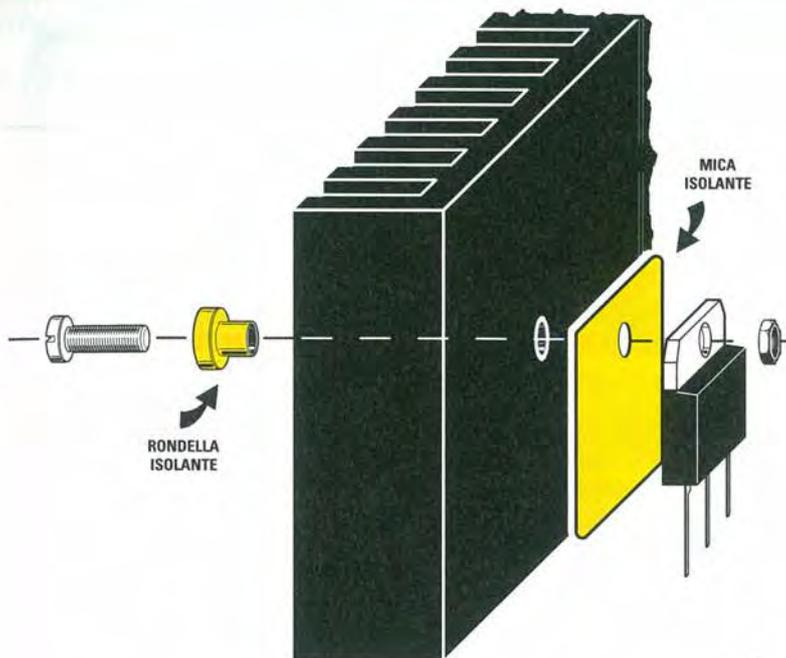
**Fig.9** Tutti i mosfet devono essere fissati alle alette di raffreddamento interponendo tra il loro corpo e il metallo dell'aletta la mica isolante inserita nel kit. Anche la vite di fissaggio va isolata con una rondella di plastica per evitare cortocircuiti.
