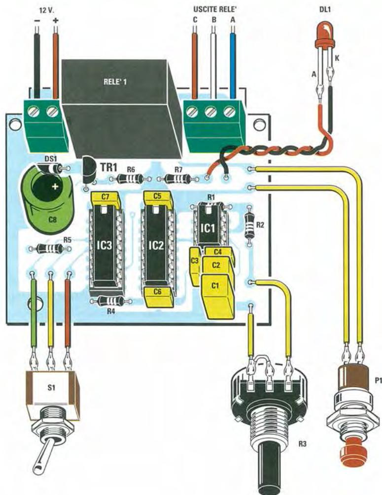
Fig.488 In alto, lo schema pratico di cablaggio del 2° temporizzatore siglato LX.5045, il cui schema elettrico è riprodotto in fig.484. Il terminale centrale del potenziometro R3 va cortocircuitato sul terminale di sinistra.
