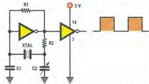
Fig.466 Utilizzando un solo inverter HC/Mos tipo **74HC04**, noi riusciamo a far oscillare un qualsiasi quarzo utilizzando questo schema. Se utilizzate un integrato TTL tipo **7404** il circuito non funziona.
