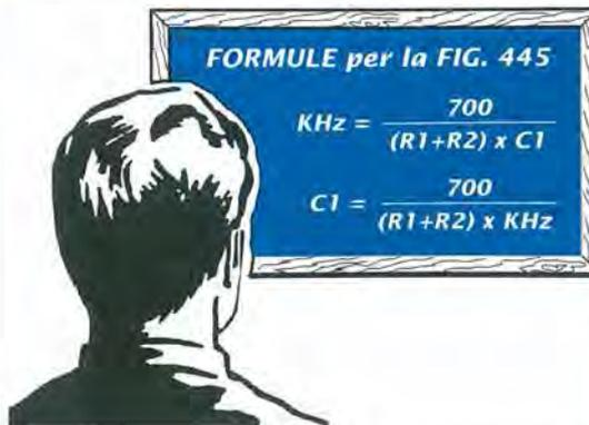
**Fig.446** Il valore delle resistenze R1-R2 deve essere espresso in kilohm e la capacità del condensatore C1 in nanofarad.
