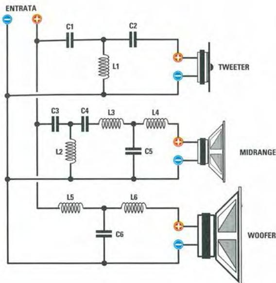
Fig.14 Schema elettrico di un filtro crossover a 3 vie con una attenuazione di 18 dB per ottava che possiamo utilizzare per pilotare degli altoparlanti da 4 ohm.
