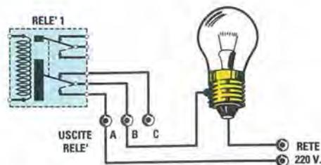
**Fig.493** Anche se sul circuito stampato abbiamo inserito per l'uscita del relè una morsetteria a 3 poli, le uscite da utilizzare sono sempre quelle indicate A-B. Quando il relè si ecciterà, i suoi contatti A-B si cortocircuiteranno internamente.
