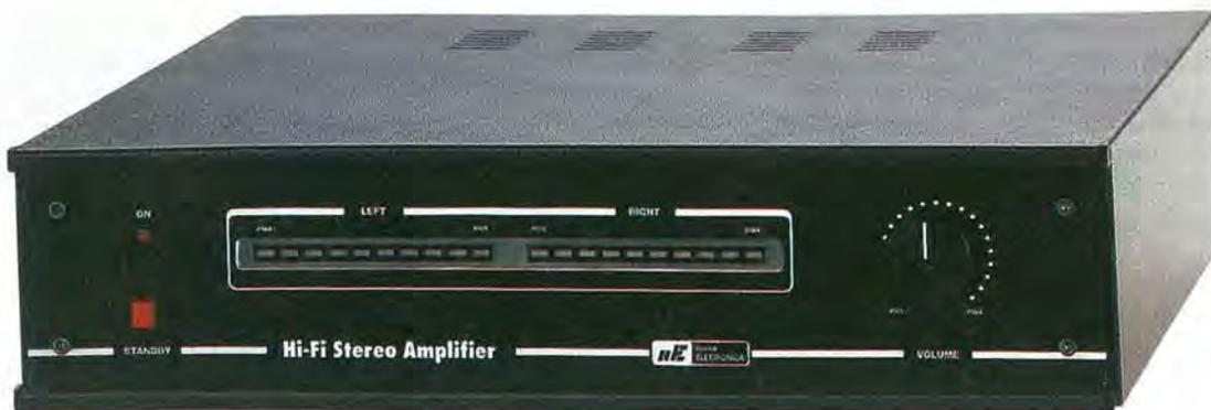
Con due soli integrati TDA.1514/A è possibile realizzare un amplificatore Stereo in grado di erogare una potenza "musicale" di 56+56 Watt su un carico di 4 ohm o una potenza "musicale" di 28+28 Watt su un carico di 8 ohm. Questo amplificatore è completo di un doppio Vu-Meter a diodi led che visualizza la potenza d'uscita sui due canali.
