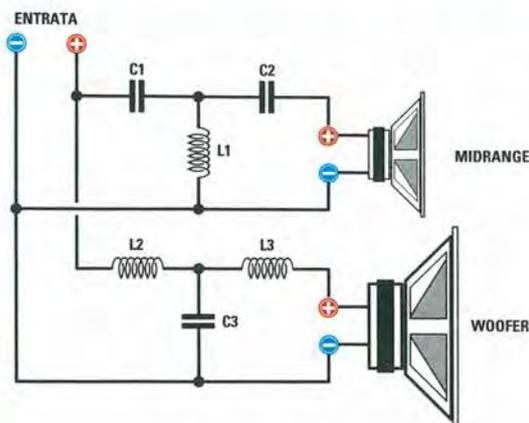
Fig.8 Schema elettrico di un filtro crossover a 2 vie con una attenuazione di 18 dB per ottava che possiamo utilizzare per pilotare degli altoparlanti da 8 ohm.
