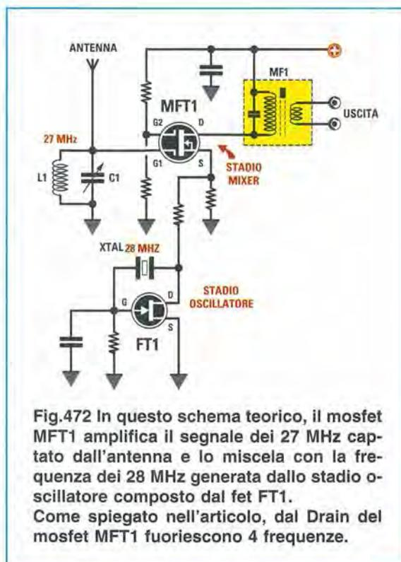
Fig.472 In questo schema teorico, il mosfet **MFT1** amplifica il segnale dei **27 MHz** captato dall'antenna e lo miscela con la frequenza dei **28 MHz** generata dallo stadio oscillatore composto dal fet **FT1**. Come spiegato nell'articolo, dal **Drain** del mosfet **MFT1** fuoriescono 4 frequenze.
