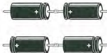
**Fig.6** Se non riuscite a reperire i condensatori elettrolitici **NON** polarizzati, potete collegare in serie due normali elettrolitici rivolgendo uno contro l'altro i due terminali positivi o i due terminali negativi.
