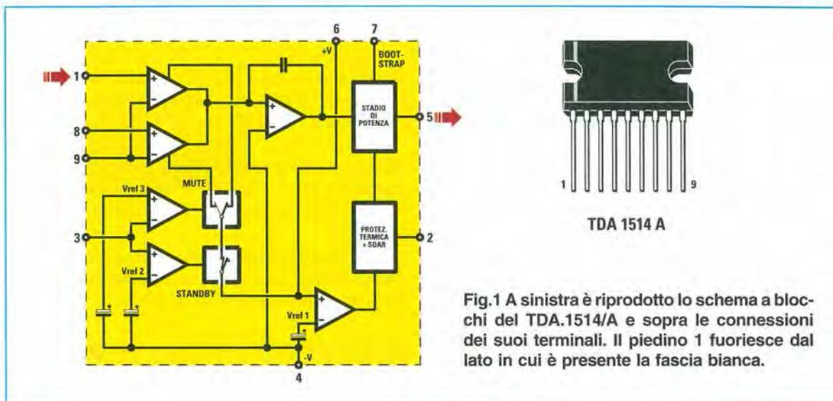
Fig.1 A sinistra è riprodotto lo schema a blocchi del TDA.1514/A e sopra le connessioni dei suoi terminali. Il piedino 1 fuoriesce dal lato in cui è presente la fascia bianca.
