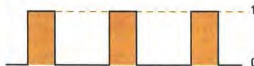
**Fig.447** Il segnale ad onda quadra che fuoriesce dall'oscillatore di fig.445 non ha un duty-cycle del 50%. Vale a dire che il tempo in cui l'impulso rimane a livello logico 1 non risulta identico al tempo in cui rimane a livello logico 0. Anche se il duty-cycle non è del 50%, il valore della frequenza in uscita non varia.
