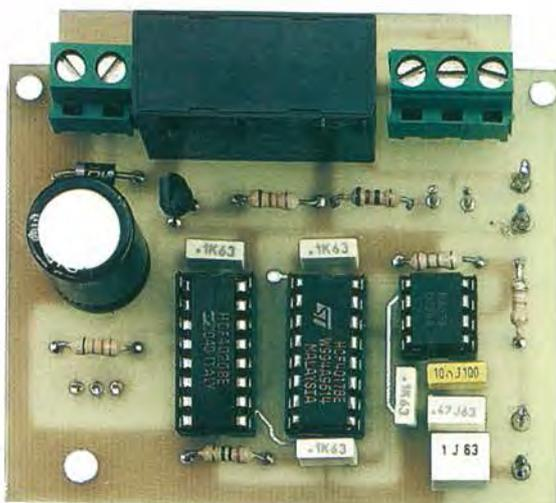
Fig.489 Di lato, la foto del circuito stampato con sopra montati tutti i componenti. Il potenziometro R3, il deviatore S1, il pulsante P1 e il diodo led DL1, vanno fissati sul coperchio del mobile come illustrato in fig. 491.
