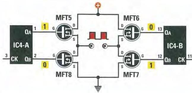
Fig.5 Per farvi capire come i 4 mosfet riescano a convertire una tensione CC in una AC dovete immaginarli come se fossero collegati a Ponte. Come spiegato nel testo, i Gate vengono pilotati dalle uscite QA-QB dei due flip-flop IC4/A e IC4/B.
