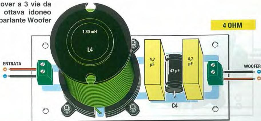
Fig.32 Schema pratico dei filtri crossover a 3 vie da 18 dB per ottava idonei per gli altoparlanti Tweeter - Midrange e Woofer da 8 ohm.
