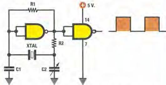
Fig.467 Collegando insieme i due ingressi di un Nand HC/Mos tipo **74HC00**, lo trasformiamo in un Inverter, quindi questo schema risulta identico a quello riportato in fig.466. Se utilizzate un integrato TTL tipo **7400** il circuito non funziona.
