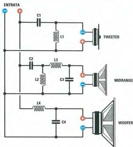
Fig.10 Schema elettrico di un filtro crossover a 3 vie con una attenuazione di 12 dB per ottava che possiamo utilizzare per pilotare degli altoparlanti da 8 ohm.
