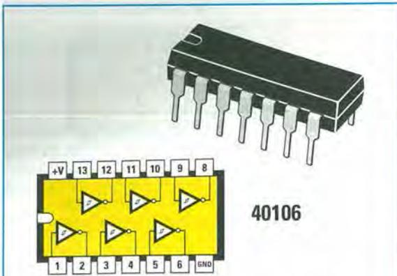
Fig.452 All'interno dell'integrato C/Mos tipo 40106 sono presenti 6 Inverter di tipo triggerato. Nel disegno riportiamo le connessioni dei terminali viste da sopra rivolgendo la tacca di riferimento a U presente sul suo corpo verso sinistra.
