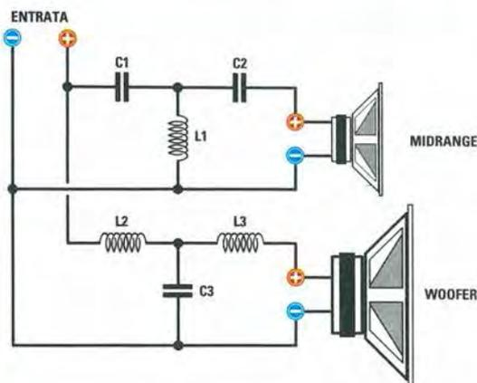
Fig.9 Schema elettrico di un filtro crossover a 2 vie con una attenuazione di 18 dB per ottava che possiamo utilizzare per pilotare degli altoparlanti da 4 ohm.
