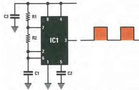
Fig.462 Schema elettrico di un oscillatore che utilizza l'integrato **NE.555**. In questo schema non dobbiamo usare per la resistenza **R1** un valore minore di **1.000 ohm**. Per **C2** possiamo usare una capacità di **10.000 picofarad** e per **C3** una capacità di **100.000 picofarad**. Nella fig.463 trovate la formula per calcolare il valore della frequenza che fuoriesce dal piedino 3.
