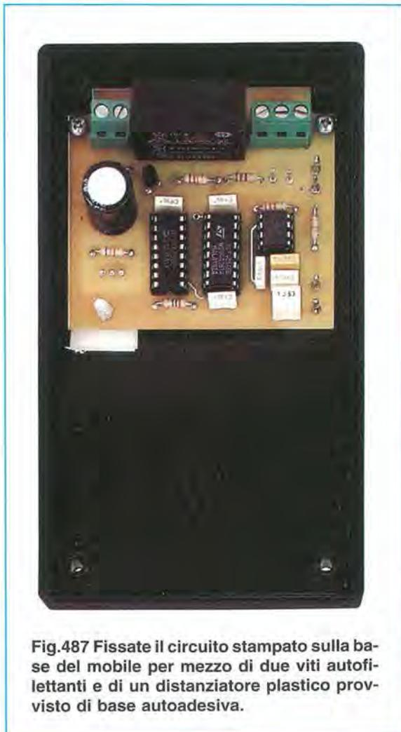
Fig.487 Fissate il circuito stampato sulla base del mobile per mezzo di due viti autofillettanti e di un distanziatore plastico provvisto di base autoadesiva.
