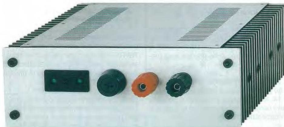
Fig.2 Nella foto riportata nella pagina di sinistra potete vedere il pannello frontale del mobile dell'inverter. Nella foto qui sopra potete invece vedere il retro di questo mobile. Sul pannello posteriore vanno fissati la presa d'uscita dei 220 volt, le due bocche di entrata dei 12 volt CC e il portafusibile.
