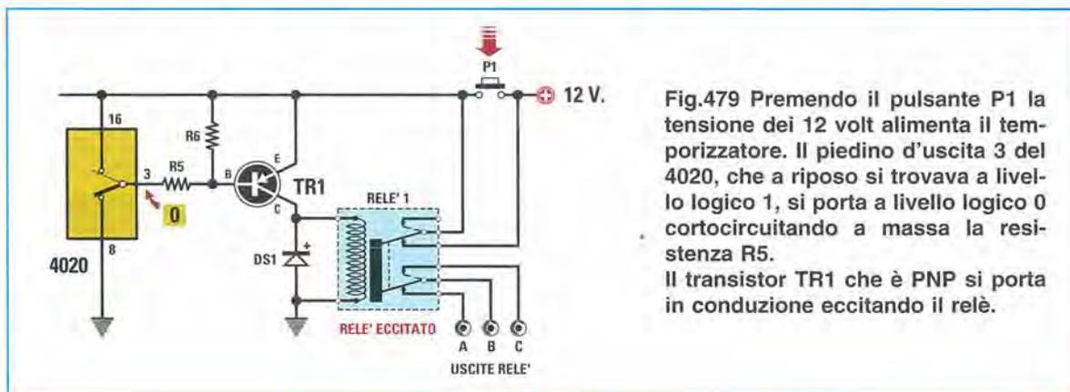
Fig.479 Premendo il pulsante P1 la tensione dei 12 volt alimenta il temporizzatore. Il piedino d'uscita 3 del 4020, che a riposo si trovava a livello logico 1, si porta a livello logico 0 cortocircuitando a massa la resistenza R5. Il transistor TR1 che è PNP si porta in conduzione eccitando il relè.
