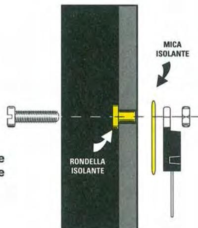
**Fig.10** Nel disegno a destra potete vedere l'aletta sezionata con la rondella isolante per la vite già inserita nel foro.
