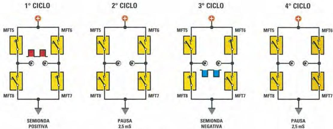
Fig.6 Quando sull'uscita QA del flip-flop IC4/A è presente un livello logico 1 sulla sua opposta uscita QB è presente un livello logico 0. Poiché il secondo flip-flop IC4/B riceve un segnale sfasato di 180°, quando sulla sua uscita QA è presente un livello logico 0 sull'opposta uscita QB è presente un livello logico 1.
