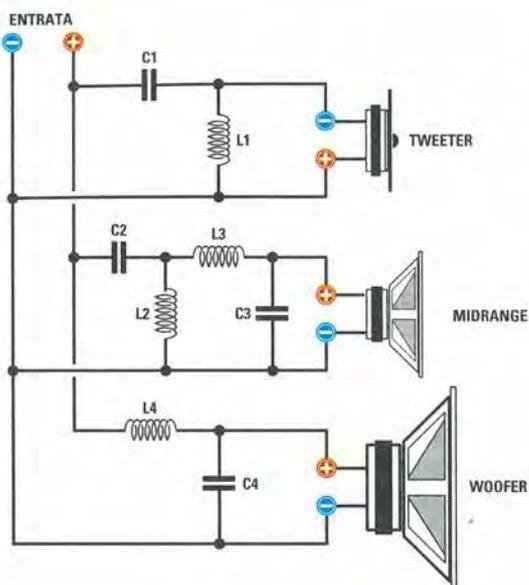
Fig.11 Schema elettrico di un filtro crossover a 3 vie con una attenuazione di 12 dB per ottava, che possiamo utilizzare per pilotare degli altoparlanti da 4 ohm.
