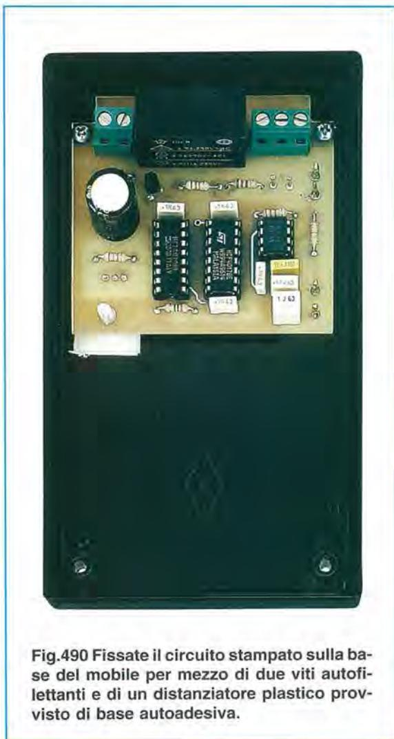
**Fig.490** Fissate il circuito stampato sulla base del mobile per mezzo di due viti autofilettanti e di un distanziatore plastico provvisto di base autoadesiva.
