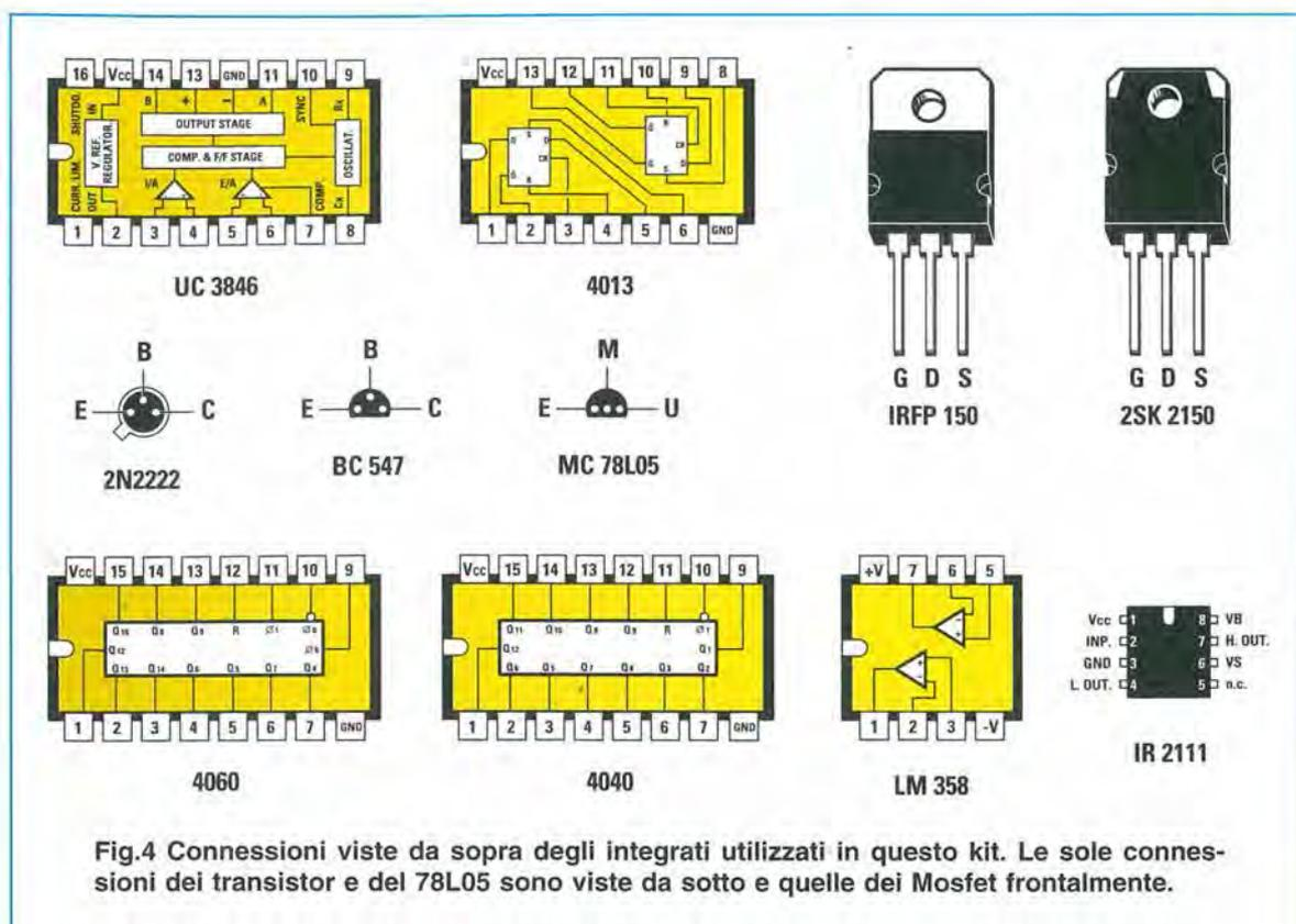
Fig.4 Connessioni viste da sopra degli integrati utilizzati in questo kit. Le sole connessioni dei transistor e del 78L05 sono viste da sotto e quelle dei Mosfet frontalmente.
