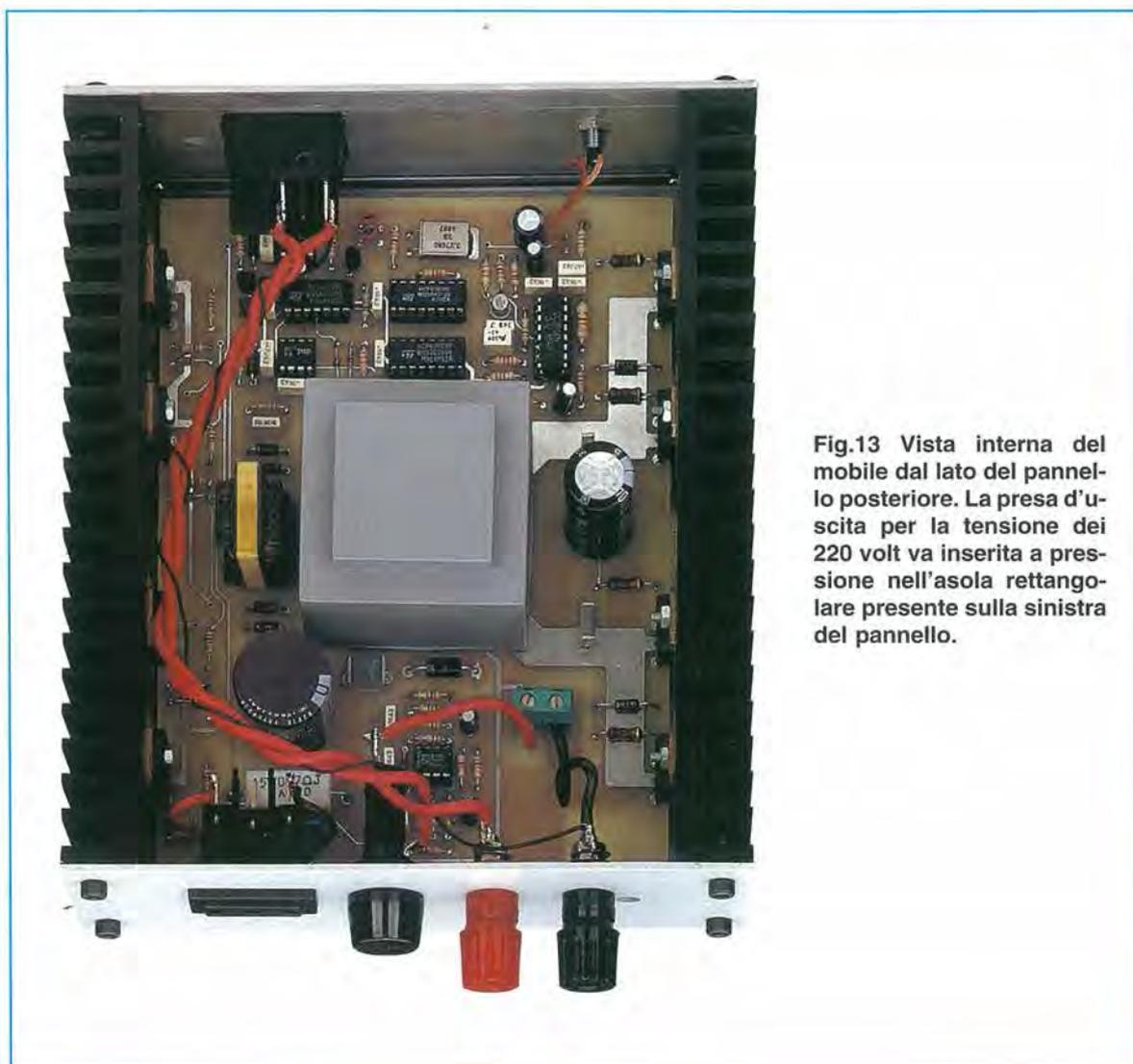
**Fig.13** Vista interna del mobile dal lato del pannello posteriore. La presa d'uscita per la tensione dei 220 volt va inserita a pressione nell'asola rettangolare presente sulla sinistra del pannello.
