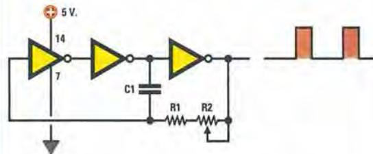
Fig.449 Schema elettrico di un oscillatore che utilizza 3 degli Inverter **NON** triggerati contenuti all'interno degli integrati 7404 o 74HC04. In fig.450 sono riportate le formule per calcolare la frequenza in **KHz** o la capacità di **C1** espressa in **nanofarad**.
