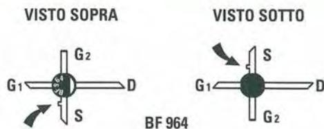
Fig.9 Quando montate i due mosfet sul circuito stampato fate molta attenzione a non confondere i loro terminali. Il terminale D è il più lungo e solo sul terminale S è presente una piccola tacca di riferimento.
