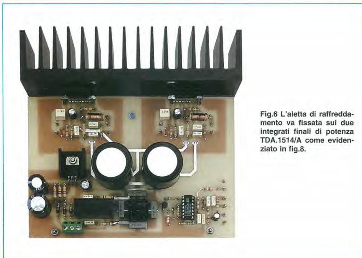
**Fig.6** L'aletta di raffreddamento va fissata sui due integrati finali di potenza TDA.1514/A come evidenziato in fig.8.
