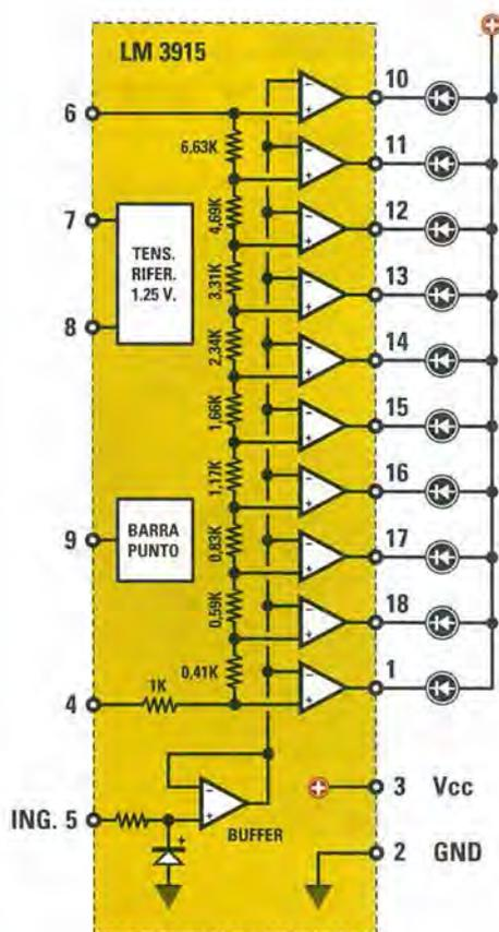
Fig.5 Schema interno dell'integrato per Vu-Meter LM.3915. Il segnale di BF applicato sul piedino 5 consente di accendere i 10 diodi led con un salto tra l'uno e l'altro di 3 dB perchè è un logaritmico.
