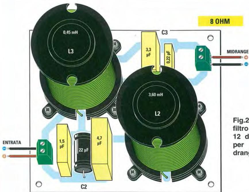
Fig.27 Schema pratico del filtro crossover a 3 vie da 12 dB per ottava idoneo per un altoparlante Midrange da 8 ohm.
