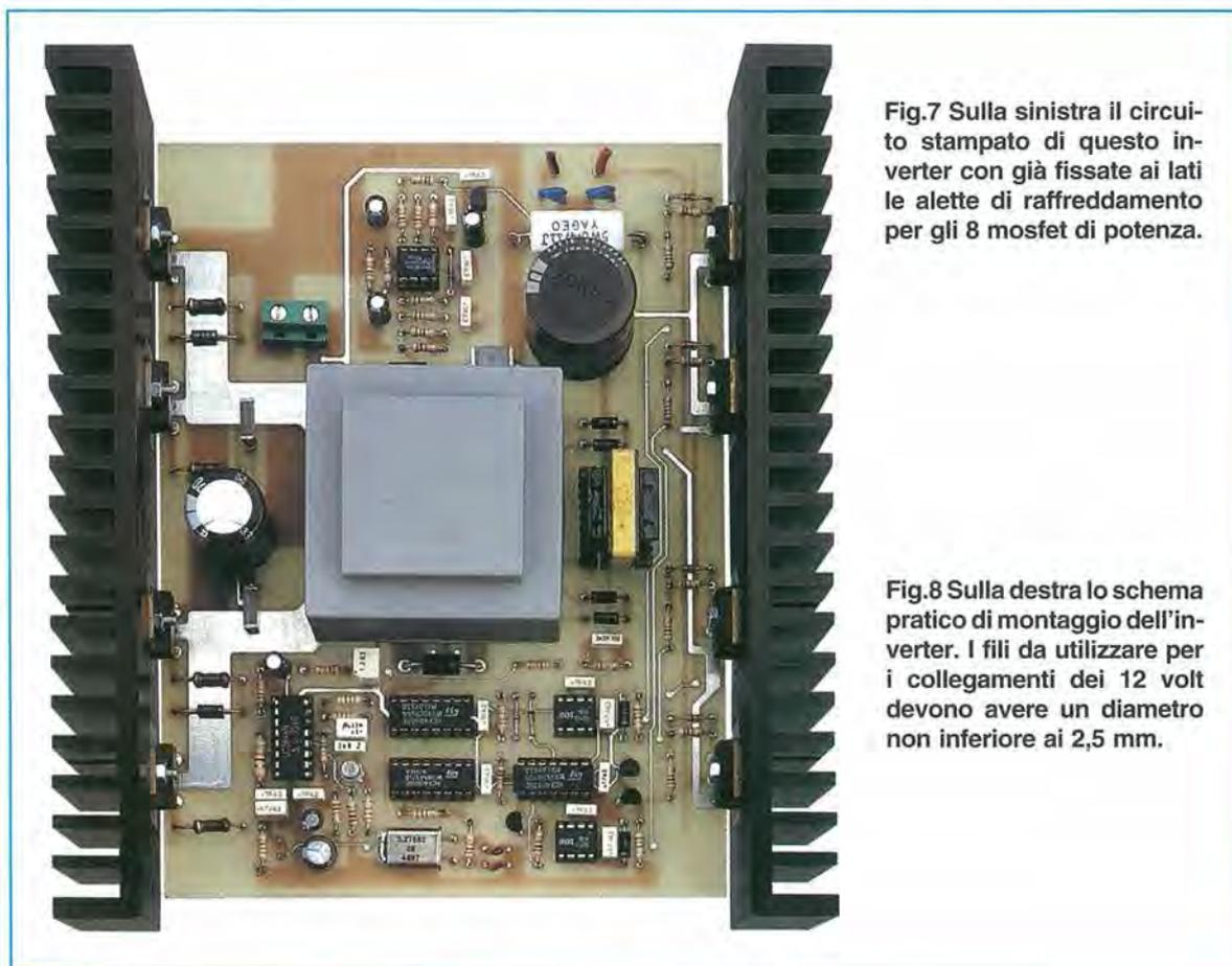
Fig.7 Sulla sinistra il circuito stampato di questo inverter con già fissate ai lati le alette di raffreddamento per gli 8 mosfet di potenza.
