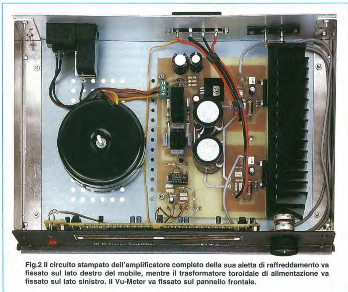
**Fig.2** Il circuito stampato dell'amplificatore completo della sua aletta di raffreddamento va fissato sul lato destro del mobile, mentre il trasformatore toroidale di alimentazione va fissato sul lato sinistro. Il Vu-Meter va fissato sul pannello frontale.
