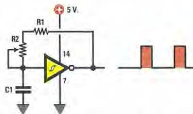
**Fig.445** Schema elettrico di un oscillatore che possiamo realizzare con gli integrati 7414 o 74HC14 utilizzando un solo Inverter di tipo triggerato. In fig.446 sono riportate le formule per calcolare la frequenza in KHz o la capacità C1 in nanofarad.
