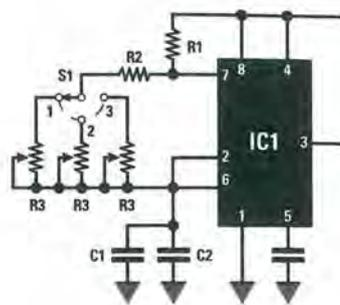
**Fig.492** Se vi serve un temporizzatore con dei tempi fissi e molto precisi, potete sostituire il potenziometro R3 con dei trimmer che tarerete esattamente sul tempo richiesto. Selezionate il trimmer richiesto tramite il commutatore rotativo S1.
