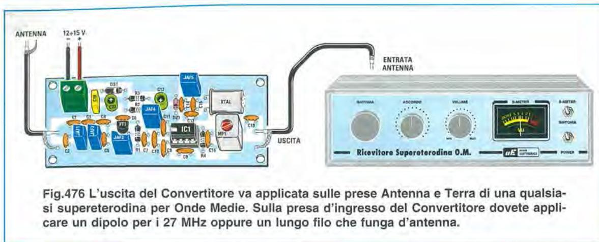
Fig.476 L'uscita del Convertitore va applicata sulle prese Antenna e Terra di una qualsiasi supereterodina per Onde Medie. Sulla presa d'ingresso del Convertitore dovete applicare un dipolo per i 27 MHz oppure un lungo filo che funga d'antenna.
