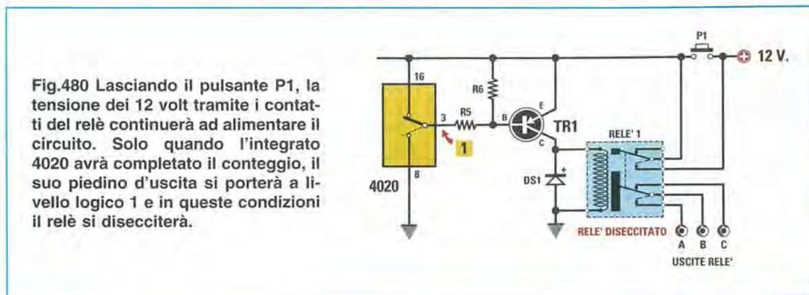
Fig.480 Lasciando il pulsante P1, la tensione dei 12 volt tramite i contatti del relè continuerà ad alimentare il circuito. Solo quando l'integrato 4020 avrà completato il conteggio, il suo piedino d'uscita si porterà a livello logico 1 e in queste condizioni il relè si disecciterà.
