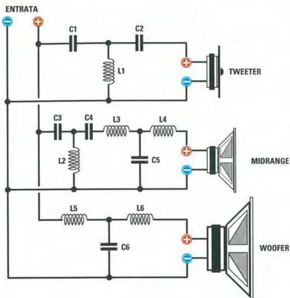
Fig.12 Schema elettrico di un filtro crossover a 3 vie con una attenuazione di 18 dB per ottava, che possiamo utilizzare per pilotare degli altoparlanti da 8 ohm.
