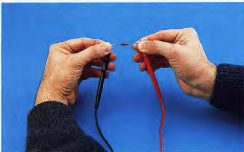
**Fig.382** Quando misurate una resistenza non toccate i due terminali con le mani perchè il tester sommerà al valore della resistenza anche quello del vostro corpo.
