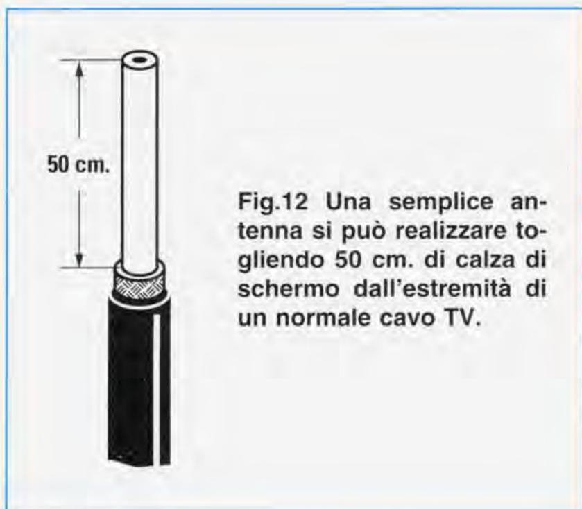
**Fig.12 Una semplice antenna si può realizzare togliendo 50 cm. di calza di schermo dall'estremità di un normale cavo TV.**
