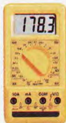
In un tester **digitale** provvisto di **4 display**, i **tre display di destra** sono completi dei loro **7 segmenti**, quindi solo questi sono in grado di visualizzare tutti i numeri da **0** a **9**, mentre il **primo display di sinistra** è in grado di visualizzare il solo numero **1** più un numero **negativo**.
