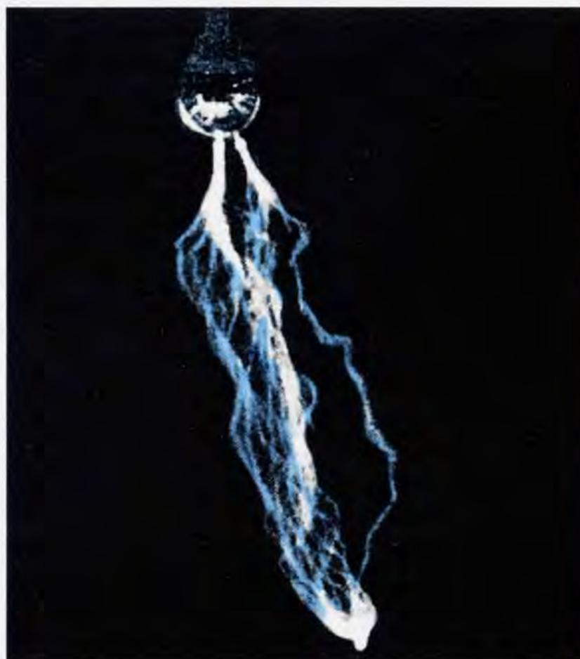
Fig.7 Se all'estremità della bobina collocare la sola punta irradiante otterrete ugualmente delle vistose scariche elettriche che si dirameranno verso l'alto. Se in sostituzione della punta metterete 3-4 aghi otterrete delle scariche più vistose.
