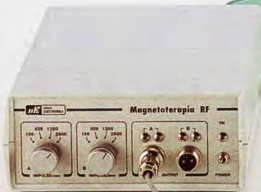
**Fig.4** In questa magnetoterapia è presente un circuito che automaticamente controlla se gli impulsi RF circolano all'interno del "panno irradiante". Se ciò non avvenisse, i due diodi led posti in prossimità della presa d'uscita si spegnerebbero all'istante. I diodi led si accendono solo quando si inserisce il panno irradiante nella presa d'uscita.
