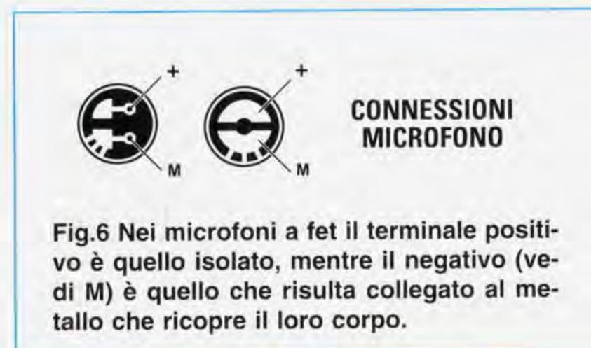
Fig.6 Nei microfoni a fet il terminale positivo è quello isolato, mentre il negativo (vedi M) è quello che risulta collegato al metallo che ricopre il loro corpo.
