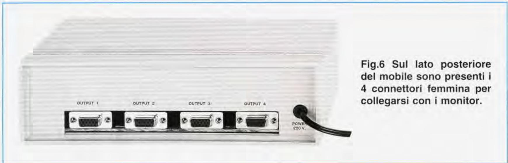
**Fig.6** Sul lato posteriore del mobile sono presenti i 4 connettori femmina per collegarsi con i monitor.
