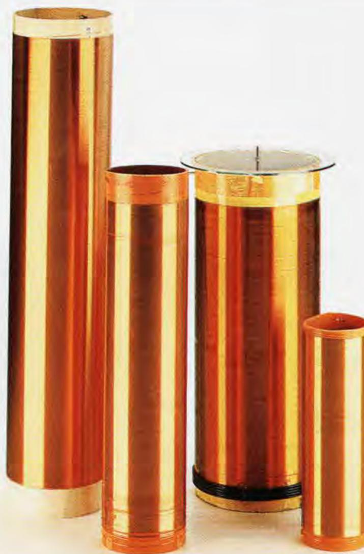
**Fig.2** Se volete autocostruirvi un trasformatore di Tesla, dovrete avvolgere su un tubo PVC più di 1.000 spire in modo da ottenere una frequenza di accordo che non risulti mai superiore a 240.000 Hertz.
