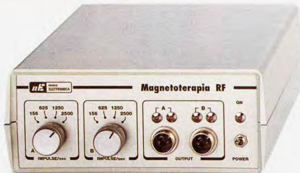
**Fig.5** Anche se sul pannello frontale sono presenti due prese d'uscita, potete usare anche un solo panno irradiante.
