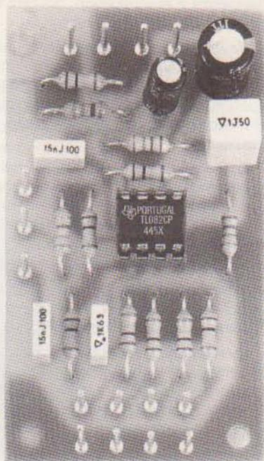
**In un primo tempo abbiamo progettato questo circuito per miscelare, in fase di progettazione, i segnali generati dal circuito di tamburo sintetizzato che presentiamo in questo stesso numero. Constatato in seguito che questo mixer si presta anche per miscelare segnali di BF provenienti da pi  microfoni o da altre sorgenti di BF, abbiamo ritenuto opportuno pubblicarlo.**
