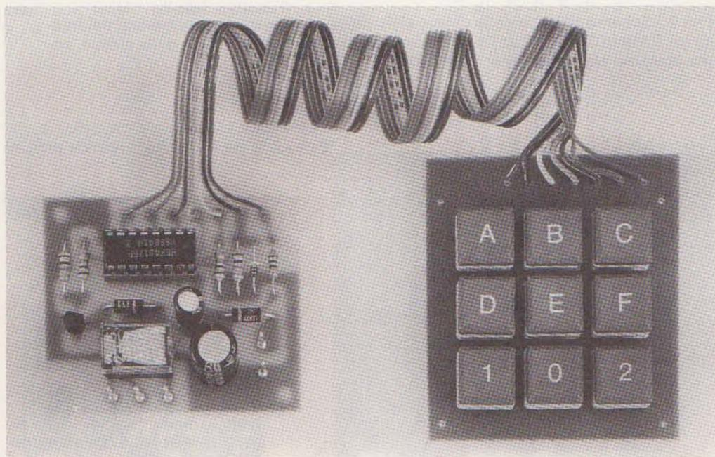
**Fig. 1** A sinistra, è visibile il circuito stampato LX.805 e a destra, il secondo circuito siglato LX.805/B, completo di 9 tasti di chiave. I cappucci di ogni tasto sono sfilabili e perciò potrete facilmente modificare la loro disposizione sulla tastiera.
