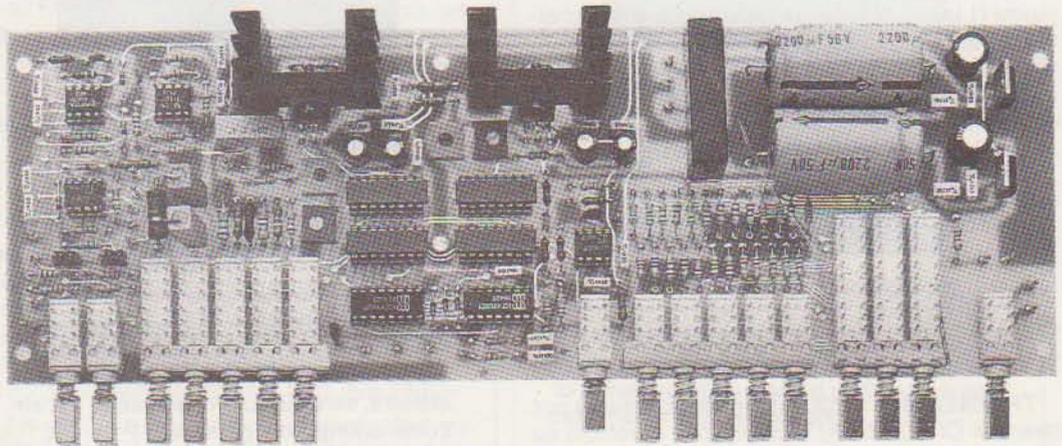
**TRIMMER R71** = Questo trimmer ci serve per tarare in ORIZZONTALE la tensione di rottura su 20 volt per quadretto.
