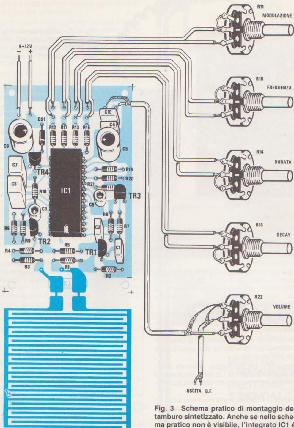
Fig. 3 Schema pratico di montaggio del tamburo sintetizzato. Anche se nello schema pratico non è visibile, l'integrato IC1 è completo di zoccolo.
