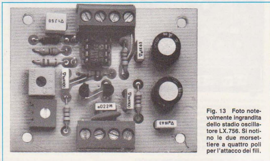
**Fig. 13** Foto notevolmente ingrandita dello stadio oscillatore LX.756. Si notino le due morsettiere a quattro poli per l'attacco dei fili.
