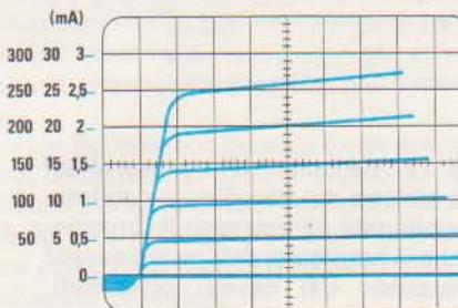
Fig. 20 Se ruoterete questa manopola sulla portata 50 millivolt  $\times$  quadretto, si dimezzerà la corrente sulla verticale dello schermo. La posizione consigliata è quella di fig. 18.
