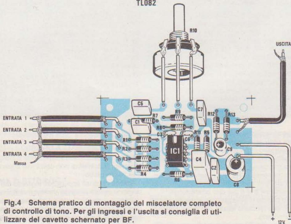
Fig.4 Schema pratico di montaggio del miscelatore completo di controllo di tono. Per gli ingressi e l'uscita si consiglia di utilizzare del cavetto schermato per BF.
