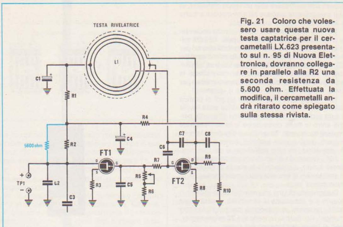
Fig. 21 Coloro che volessero usare questa nuova testa captatrice per il cercametri LX.623 presentato sul n. 95 di Nuova Elettronica, dovranno collegare in parallelo alla R2 una seconda resistenza da 5.600 ohm. Effettuata la modifica, il cercametri andrà ritarato come spiegato sulla stessa rivista.
