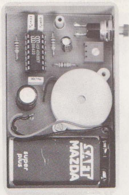
La pila di alimentazione trova posto nel vano presente in basso sotto alla capsula piezoelettrica.
