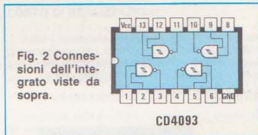
Fig. 2 Connessioni dell'integrato viste da sopra.
