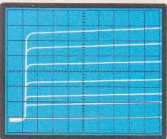
Fig. 10 Per questo motivo abbiamo inserito nel circuito l'amplificatore operazionale siglato IC7/A. Amplificando  $\times 10$  la tensione presente sull'emettitore, sullo schermo appariranno delle curve caratteristiche ben spaziate.
