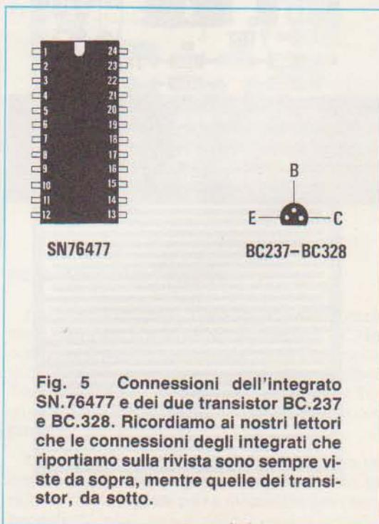
Fig. 5 Connessioni dell'integrato SN.76477 e dei due transistor BC.237 e BC.328. Ricordiamo ai nostri lettori che le connessioni degli integrati che riportiamo sulla rivista sono sempre viste da sopra, mentre quelle dei transistor, da sotto.
